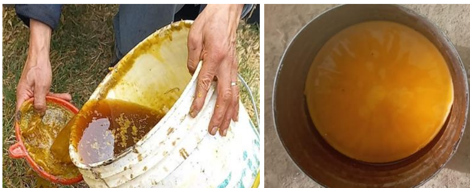
Figura 4. Separación de los cristales de cera del agua con ayuda de un filtro fino (Izq.) y segundo proceso, se derritió toda la cera purificada en agua limpia y caliente. Se dejó enfriar de forma natural, o sea lentamente.
