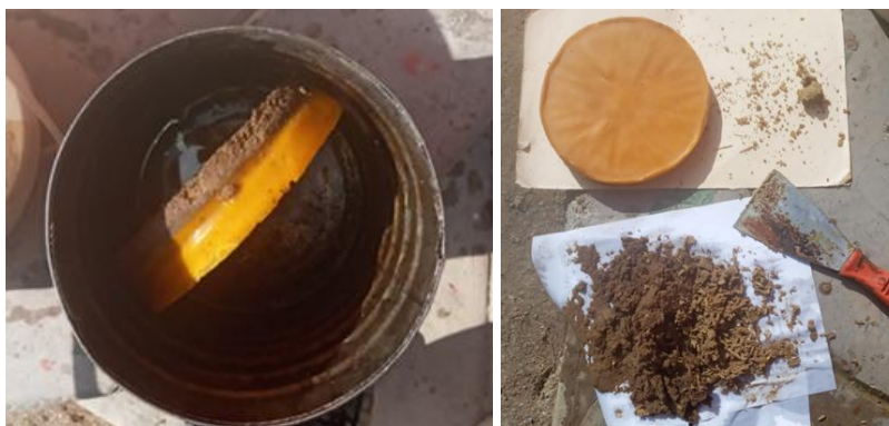
Figura 5. En la parte superior se forma el bloque sólido de cera, y en la parte inferior se adhieren las impurezas solubles, presentes en la solución (Izq.) y con una espátula se retira las impurezas para obtener la cera purificada (Der.).
